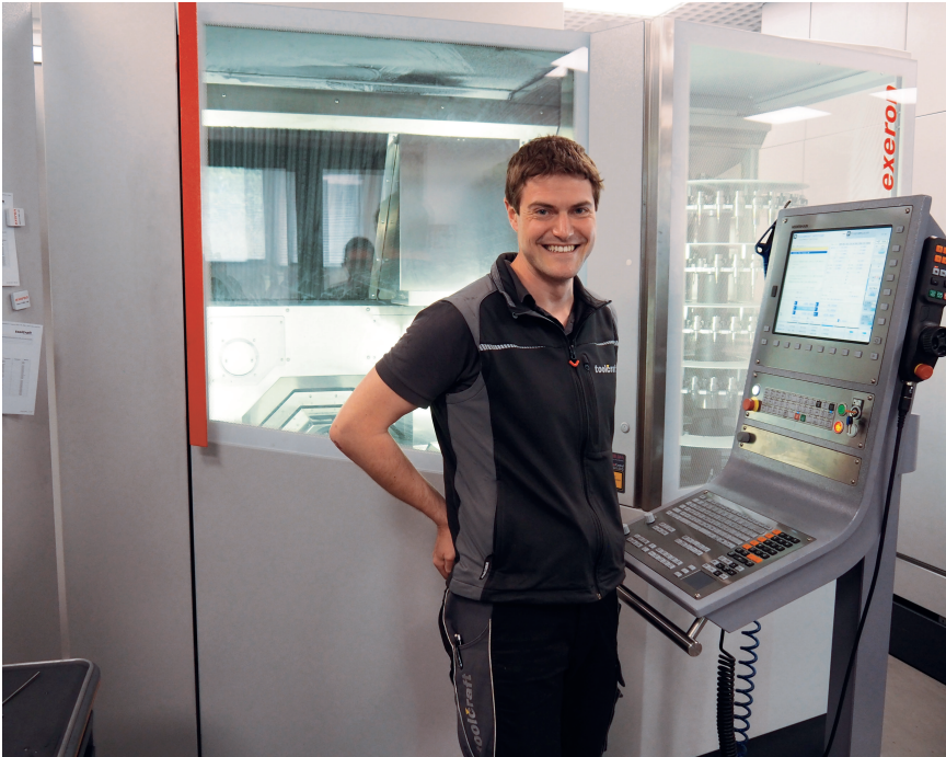
Inhouse-Fertigung: Projektleiter Christoph Wechsler vor der Exeron MP7 HSC, die über Paletten bestückt wird und das Fräsen der Elektroden übernimmt
